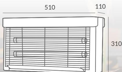
El funcionamiento de los eliminadores electrónicos de insectos Pritec se basa en la combinación del efecto de atracción proporcionado por los tubos de luz actínica y el eficaz, rápido y seguro sistema de eliminación por electrocución.
